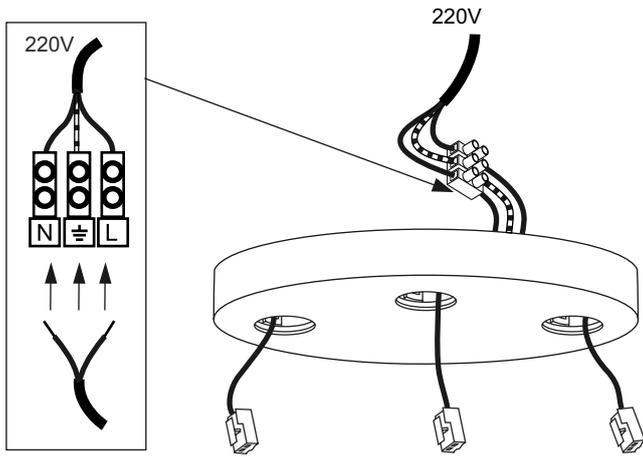
**ВАЖНО:** Установка светильника должна производиться при обесточенной электросети.
